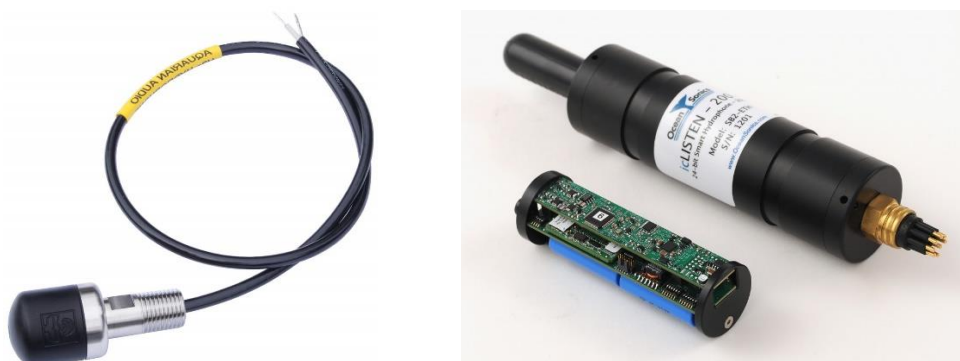
Figura 18: Tipos de Hidrófonos (izquierda – Analógico; Derecha – Digital)
