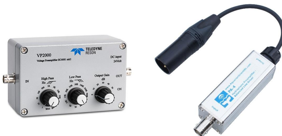
Figura 19: Tipos de Preamplificadores (Izquierda - con ganancia ajustable y filtros incorporados, Derecha – ganancia fija y sin filtros)
