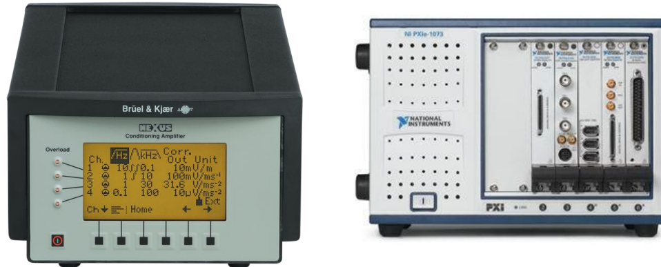
Figura 20: Sistema de adquisición de datos (Izquierda – específico para señales acústicas o de vibraciones; Derecha – Genérico modular)
